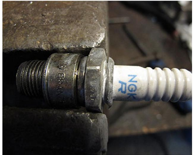
Découper le culot de la bougie au Dremel ou équivalent à l'aide d'un disque à tronçonner.
