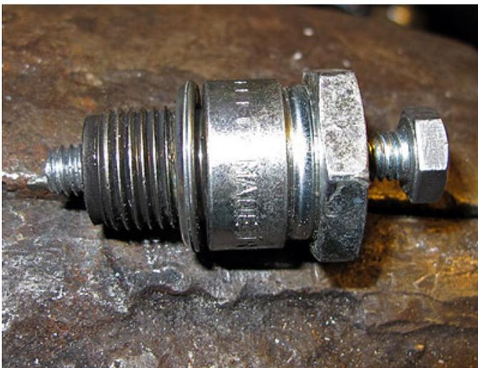
La pige est terminée, en vissant d'un tour la vis avance ou recule de 1 mm. Choisir une longueur de vis adaptée à l'usage.
