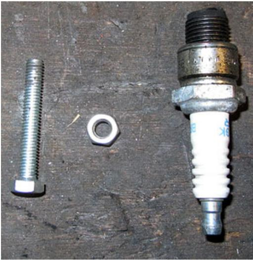
Matériel : une vieille bougie, une vis et un écrou de 6 x 100.
